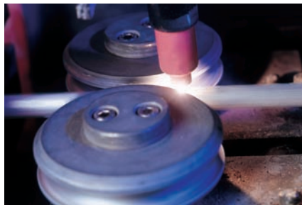
Das Aluminium wird stumpf im WIG-Verfahren verschweißt.
