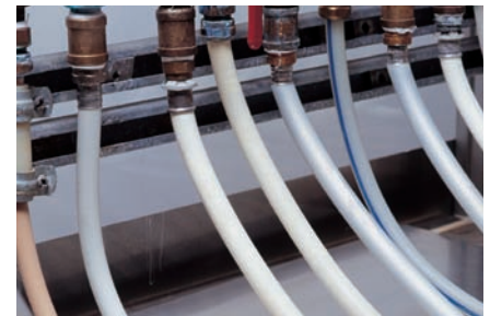
Simulationstest zur Prüfung thermisch bedingter Längenänderung
