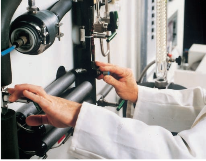
Kontinuierlich durchgeführte Messungen zur Sauerstoffdichtheit der Hewing PE-Xc-Rohre für Heizungsanwendungen belegen, dass die in der DIN festgelegten Grenzwerte deutlich unterschritten werden.
