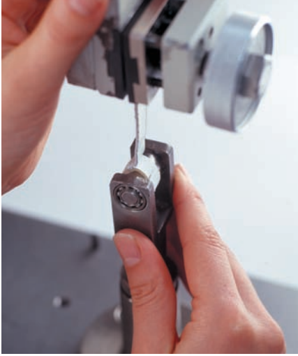
Der feste Verbund aller Schichten wird im Rahmen von Zugprüfungen kontrolliert.
