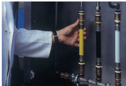
Auf der hauseigenen Druckstoß-Prüfanlage werden PE-Xc-Rohre laufend unter extremen Belastungen getestet.
